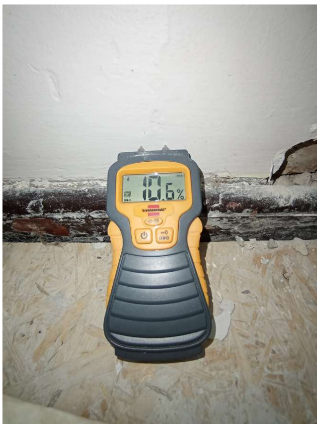
fot.20. widoczny odczyt wilgotności tynku wewnętrznego
