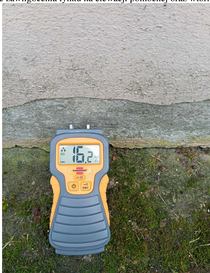
fot.43. widoczne pomiar wilgotności ściany w rejonie cokołu elewacji północnej
